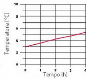
Grafici delle prestazioni termiche medie con temperatura ambiente di 25°C e contenitori riempiti per il 70% del volume utile.
