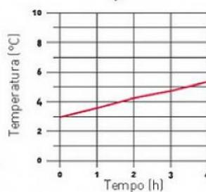
Grafici delle prestazioni termiche medie con temperatura ambiente di 25°C e contenitori riempiti per il 70% del volume utile.
