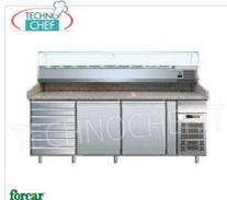
**Mostrador de pizza refrigerado 2 PUERTAS, +7 CAJONES Vitrina refrigerada para ingredientes, sin refrigerar, fondo 380 mm, capacidad 9 recipientes GN 1/3 (325x175 mm), temp. +2/+8°C, Ventilado, ECOLÓGICO en Clase B, Gas R290, V.230/1, Kw.0,26, dim.mm.2025x800x1445h**
