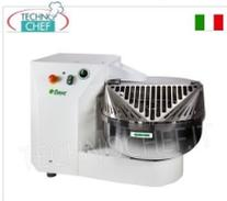
Amasadora de horquilla de 30 kg con cuba de 35 lt, 1 velocidad, MONOFÁSICA, V.230/1, Kw.0,75, Peso 140 Kg, dim.mm.1000x650x610h
