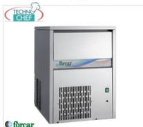
Fabricador de hielo en cubitos, producción 100 kg/24 horas, capacidad de almacenamiento 60 kg, exterior en acero inoxidable, versión refrigerada por aire, V 230/1, Kw 1,2, dimensiones mm 740x605x1015h
