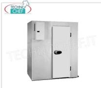
Cámara frigorífica prefabricada, apta para bajas temperaturas (-14°-22°), fabricada con paneles sándwich modulares, de 100 mm de espesor, con puerta giratoria y suelo, 5,65 metros cúbicos, dimensiones exteriores, mm 1840x1840x2300h
