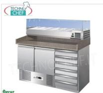
**MOSTRADOR DE PIZZAS REFRIGERADO, 2 PUERTAS, + 6 CAJONES** Vitrina refrigerada para ingredientes, sin refrigerar, de 33 cm de profundidad, para 6 recipientes GN 1/4 (mm 265x162), temp. +2°/+8°C, V.230/1, Kw.0.155, dim.mm.1400x700x1465h
