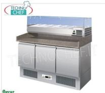
**MOSTRADOR REFRIGERADO PARA PIZZA, 3 PUERTAS**, Vitrina refrigerada de 380 mm de profundidad, capacidad 4 recipientes GN 1/3 (mm 325x175) + 1 GN 1/2 (mm 325x265), temp. +2°/+8°C, Estático, **ECOLÓGICO** en Clase C, Gas R600a, V.230/1, Kw.0.235, dim.mm.1400x700x1465h
