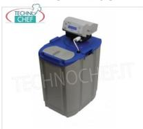
Descalcificador-purificador automático de agua con mueble de 12 lt, con 9 lt de RESINAS, Serie AL, válvula cronométrica ALIA, caudal máximo 1400 lt/h, conexión de agua 3/8"G, pantalla LCD y aviso de baja sal, V.230/1, Watt 4, Peso 15 Kg, dim.mm.285x405x595h
